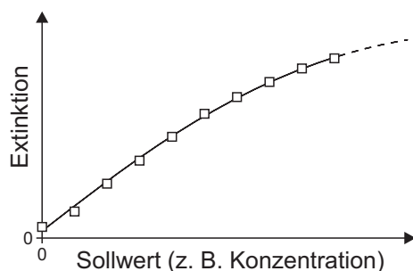
Bild 4-3 Beispiel einer Parabel-Kalibrierfunktion nach 10 Punkte-Kalibrierung
