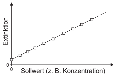
Bild 4-1 Beispiel einer linearen Kalibrierfunktion nach 10 Punkte-Kalibrierung
